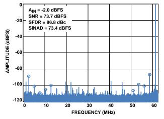
FIGURE 21. SINGLE-TONE SPECTRUM AT 190MHz (125MSPS)
