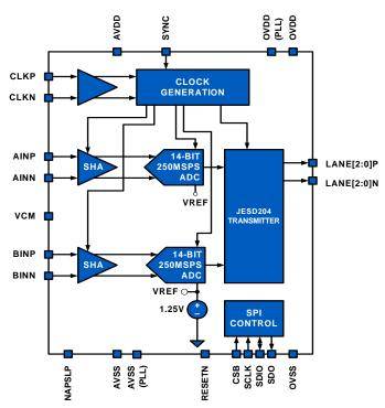
FIGURE 2. BLOCK DIAGRAM
