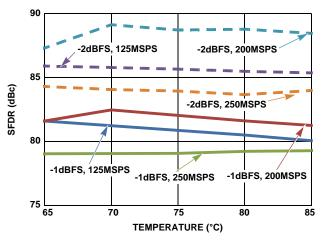
FIGURE 41. TYPICAL SFDR PERFORMANCE VS TEMPERATURE,
