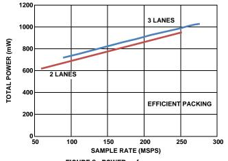
FIGURE 9. POWER vs  $f_{\mbox{SAMPLE}}$
