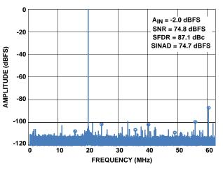
FIGURE 20. SINGLE-TONE SPECTRUM AT 105MHz (125MSPS)
