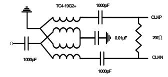
FIGURE 46. RECOMMENDED CLOCK DRIVE
