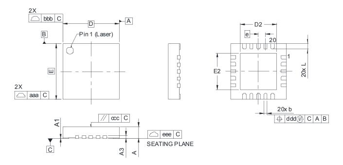
Figure 19. 20-Pin Quad Flat No-Lead (QFN)
