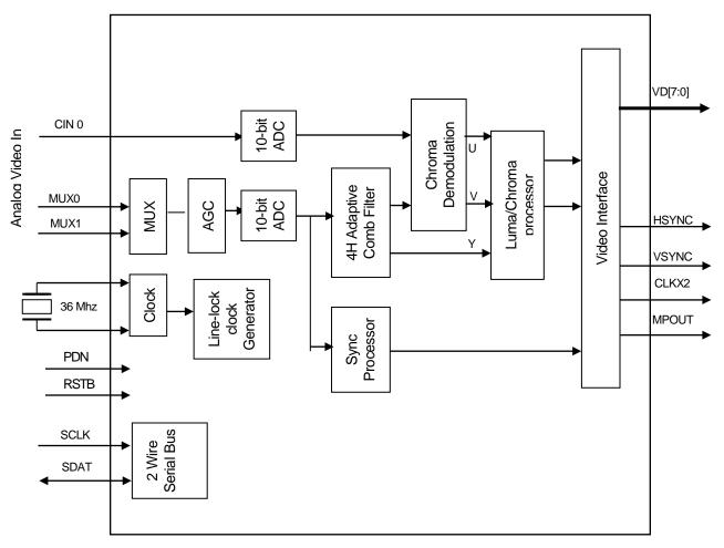
FIGURE 1. TW9960 BLOCK DIAGRAM
